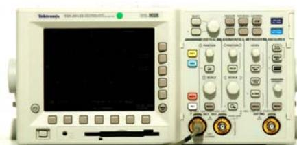
**TDS3012B** Digital Phosphor Oszilloskop, 2 Kan., 100 MHz, 2,5 GSa/s, inkl. TDS3FFT € 2.500,--
