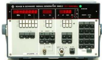
**SMS2/B2** Signalgenerator, 0,1 – 1040 MHz, AM, FM, mit TCXO **€ 900,--**
