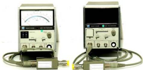
**8900C** Peak-Power-Meter, analog, mit Sensor, 0 – +20 dBm, 100 MHz – 18 GHz      € 1.800,--
