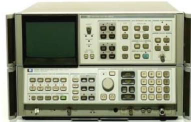
**8568B** Spektrumanalysator, 100 Hz – 1,5 GHz, Labgerät, 10 Hz Auflösung, HP-IB € 2.600,--
