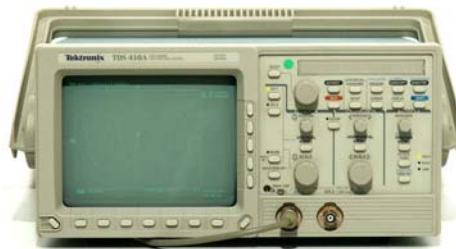
**TDS410A** Speicher-DSO mit zwei Kanälen, 200 MHz Bandbreite, 100 MSa/s, GP-IB € 1.200,--
