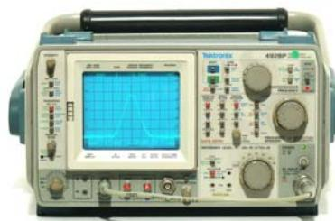
**492BP** Spektrumanalysator, 50 Hz – 21 GHz, optionaler 2. ZF-Ausgang, GP-IB € 3.250,--
